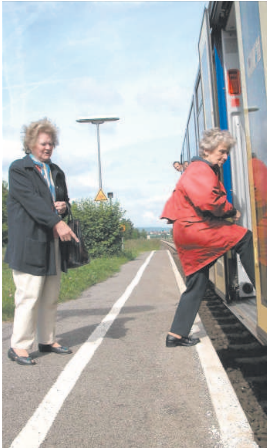
Das Ein- und Aussteigen am Groß DünGENER Bahnhof hat seine Tücken. Der Höhenunterschied zwischen Bahnsteigkante und der Zugtür beträgt bis zu 30 Zentimeter.
